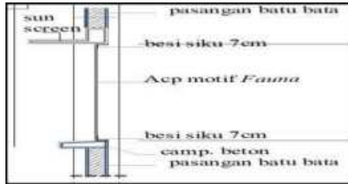
Gambar 5.14.: penebalan tembok pada bangunan
