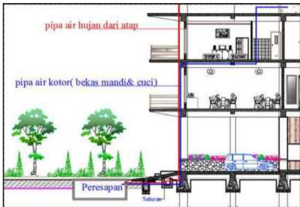
Gambar 5.49 : Skema Konsep Utilitas air kotor
