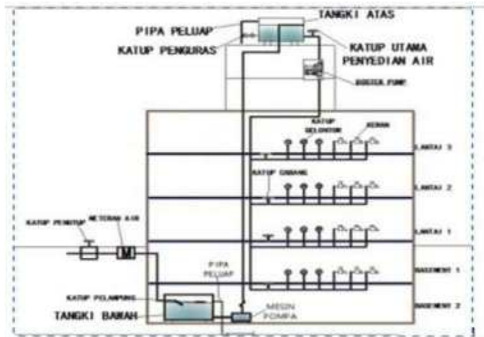
Gambar 5.53. Konsep skema air bersih pada bangunan
