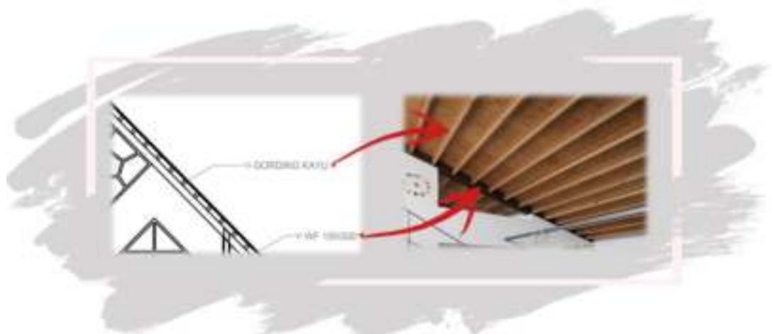
Gambar 5. 46 Konstruksi struktur atap Sumber: Sketsa penulis
