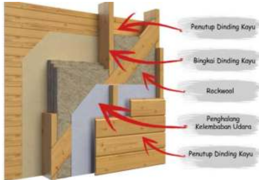
Gambar 5. 45 Lapisan Dinding Kayu Sumber: Sketsa Penulis
