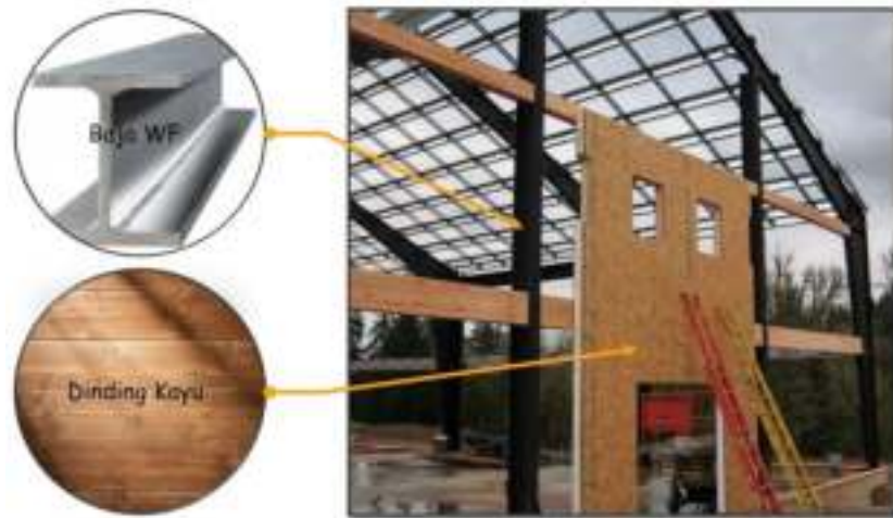
Gambar 5. 43 Struktur tengah Sumber: Sketsa Penulis
