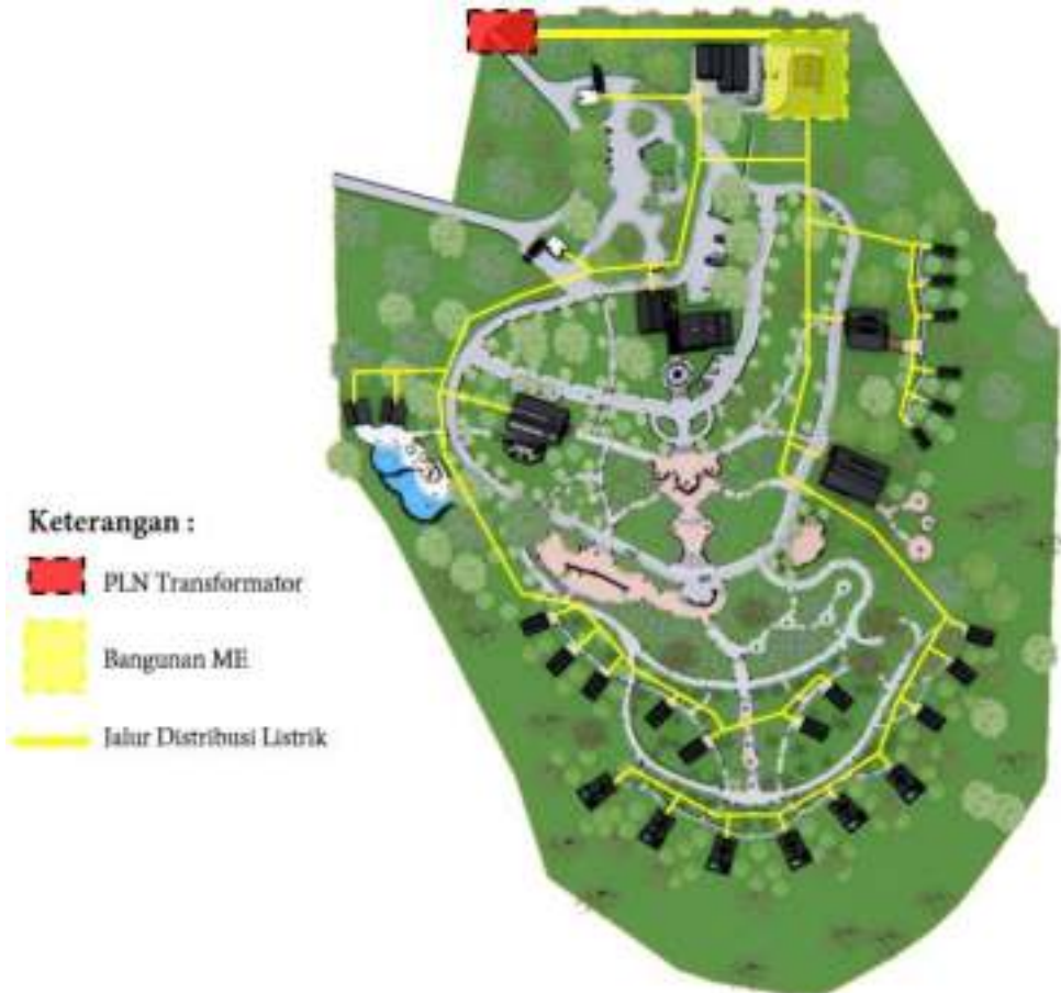
Gambar 5. 58 Sistem Pendistribusian Listrik Pada Tapak Sumber : Sketsa Penulis, 2022
