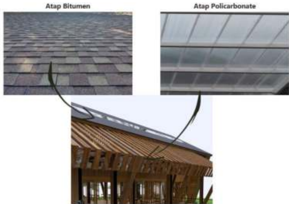
Gambar 5. 53 Atap Jenis bitumen dan Polycarbonate Sumber : Sketsa Penulis, 2022
