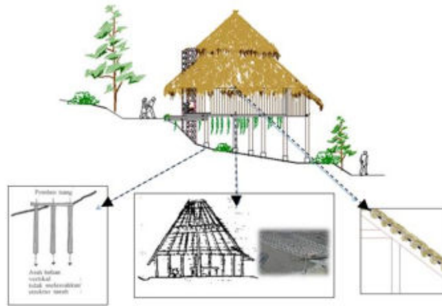
Gambar 5.13 Konsep struktur & konstruksi
