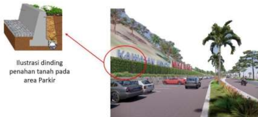
Gambar 5. 30 Dinding Penahan Tanah pada Tapak.
