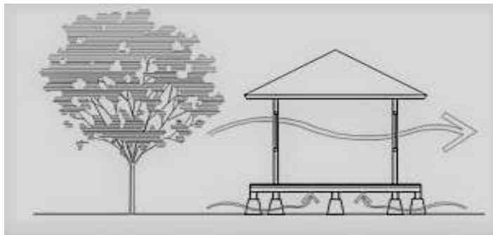
Gambar 5.24 sirkulasi udara pada bangunan berpanggung
