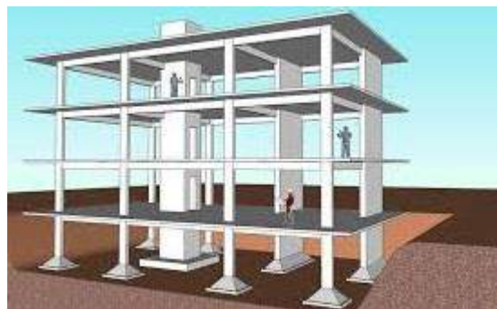
Gambar 112 struktur rangka kaku pada akademi seni tari sumber: olahan penulis
