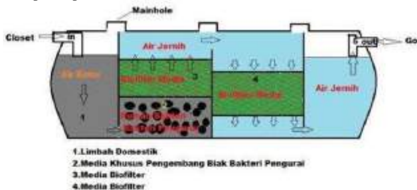
Gambar 126 sistem jaringan bio septiktank sumber: google
