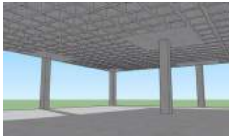
Gambar 115 sistem waffle slab pada ruang studio tari sumber: Olahan Penulis
