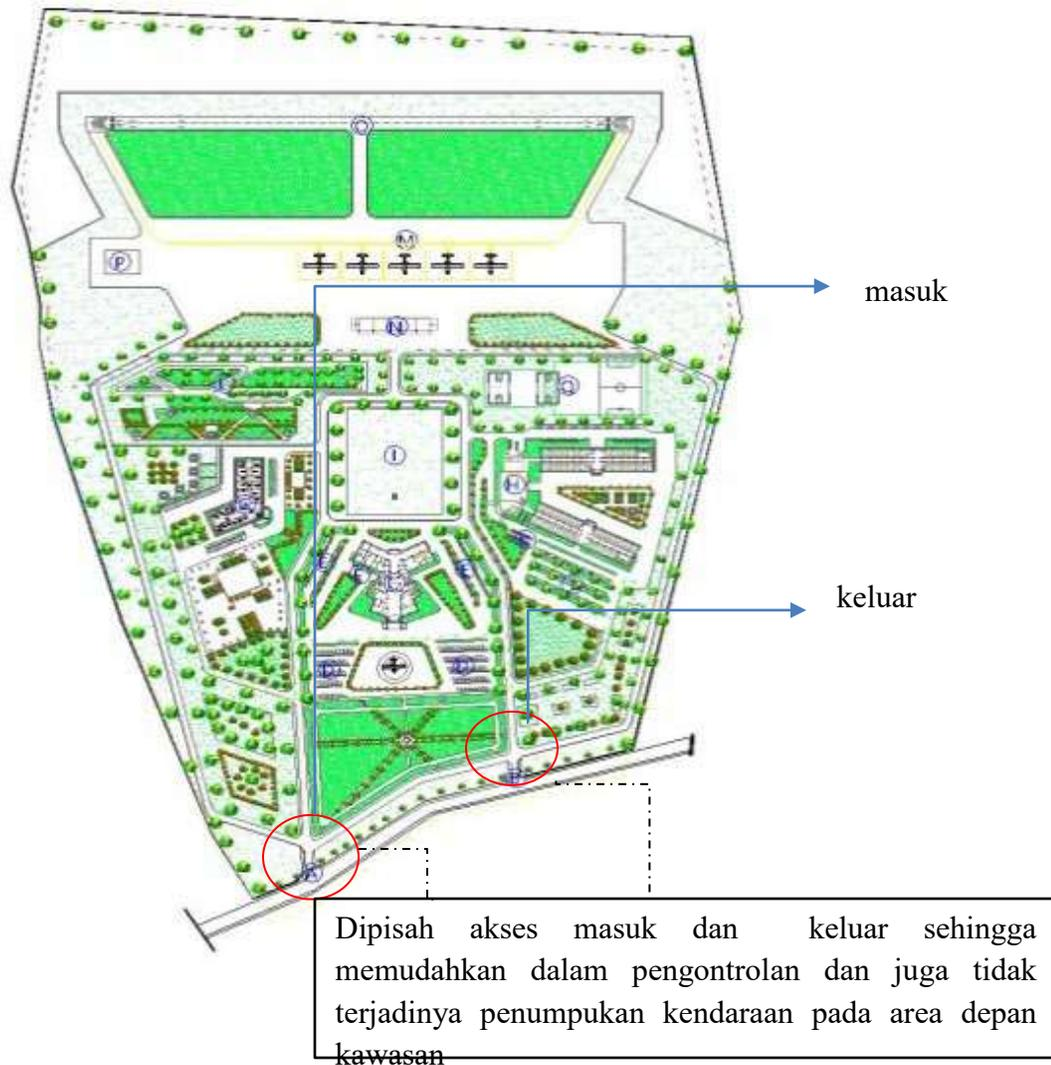
Gambar 5. 3 penempatan akses masuk-keluar tapak
