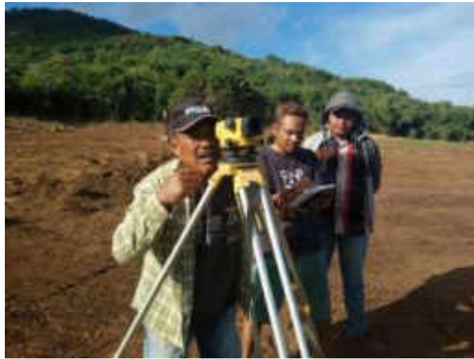
Gambar 4. 6 Pengukuran beda tinggi area dumping
