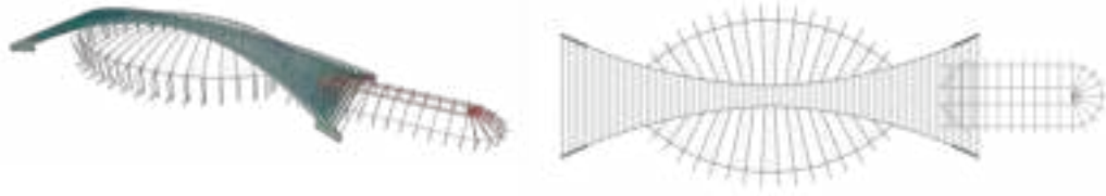
Gambar 5. 45 Konsep rencana struktur rangka gedung Aquatic Center
