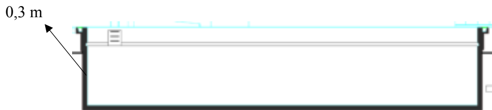
Gambar 5. 46 Struktur beton bertulang pada kolam renang
