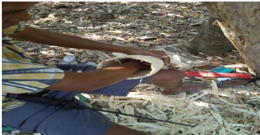
Gambar 4.15 Pembersihan dan pemerataan ruang resonansi Menggunakan pahat (Dok. Alan Makul 2022)
