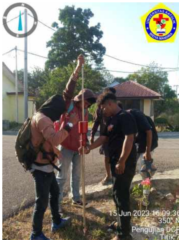
Gambar 4.14. Proses Pengujian DCP Pada (STA 0+125) Sumber: Hasil Dokumentasi Survey (2023)
