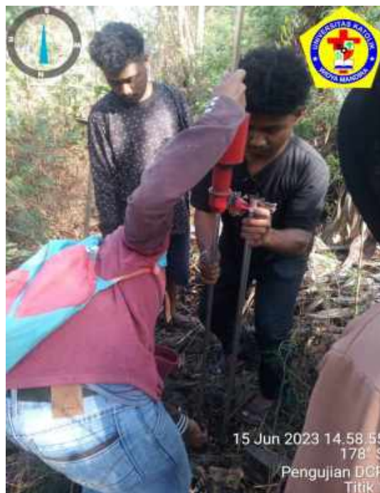
Gambar 4.6. Proses Pengujian DCP Pada (STA 0+025) Sumber: Hasil Dokumentasi Survey (2023)
