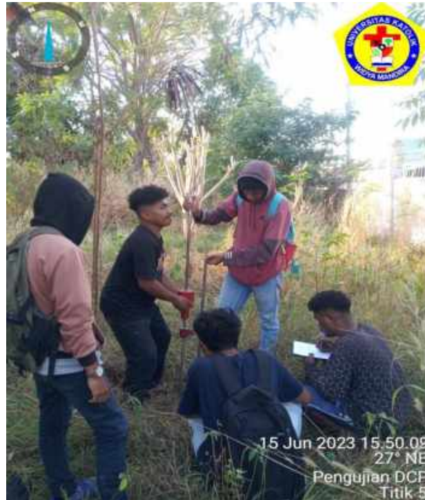
Gambar 4.12. Proses Pengujian DCP Pada (STA 0+100)
