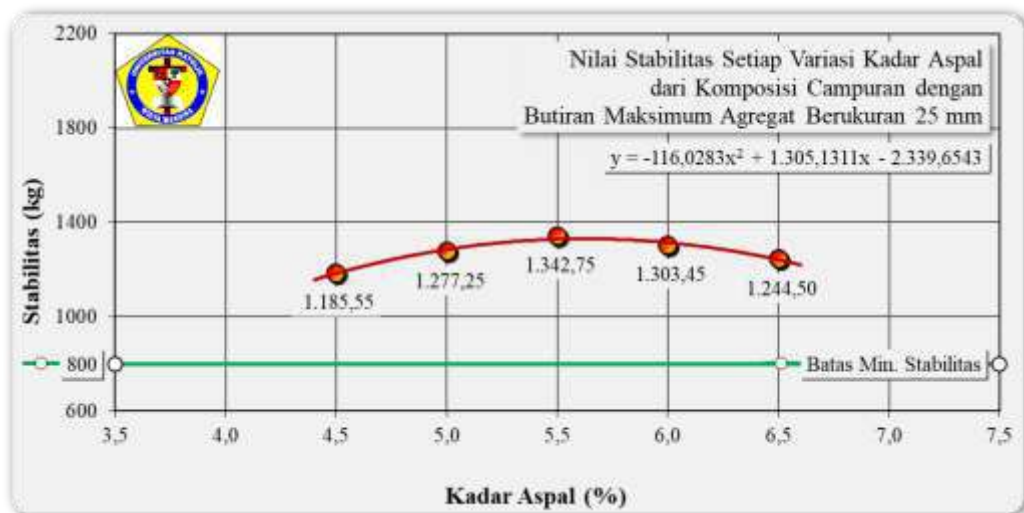
Gambar 4.5 Grafik Nilai Stabilitas Setiap Kadar Aspal dari Komposisi Gradasi Agregat Gabungan dengan Butiran Maksimum Agregat Berukuran 25 mm Sumber: Hasil Pengujian Laboratorium PT. CBJA, 2023
