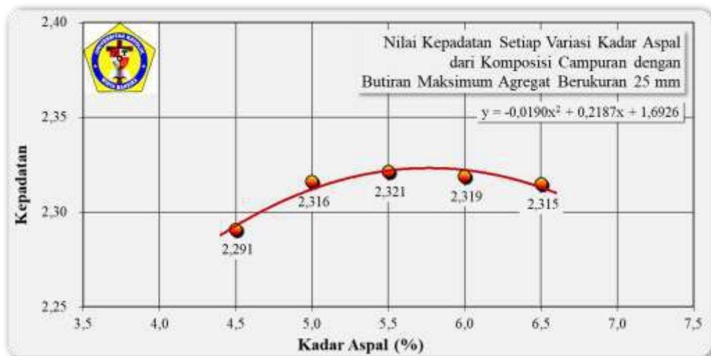
Gambar 4.3 Grafik Nilai Kepadatan Setiap Kadar Aspal dari Komposisi Gradasi Agregat Gabungan dengan Butiran Maksimum Agregat Berukuran 25 mm Sumber: Hasil Pengujian Laboratorium PT. CBJA, 2023
