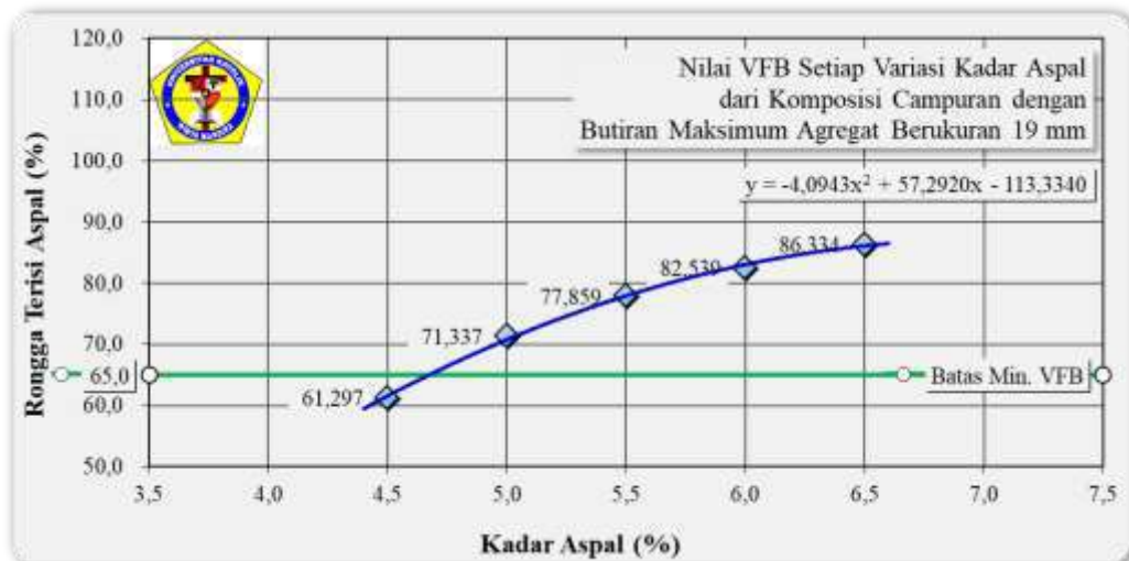
Gambar 4.16. Grafik Nilai VFB Setiap Kadar Aspal dari Komposisi Gradasi Agregat Gabungan dengan Butiran Maksimum Agregat Berukuran 19 mm
