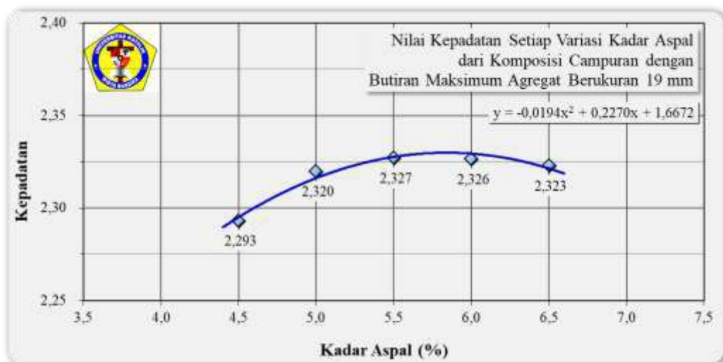
Gambar 4.4 Grafik Nilai Kepadatan Setiap Kadar Aspal dari Komposisi Gradasi Agregat Gabungan dengan Butiran Maksimum Agregat Berukuran 19 mm Sumber: Hasil Pengujian Laboratorium PT. CBJA, 2023
