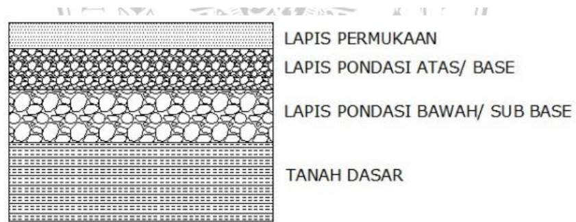
Gambar 2.2. Susunan lapis konstruksi Perkerasan Lentur Jalan
