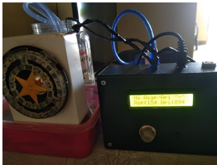
Gambar 4. 5 Prototype alat pendeteksi kebakaran dan pemadaman otomatis
