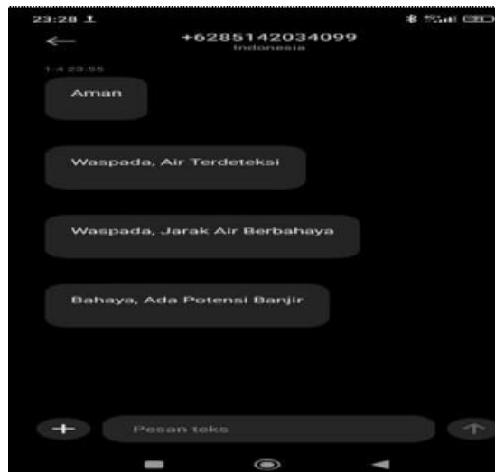
Gambar 5.4 Pembacaan sensor soil moisture > 60% dan ultrasonik < 100cm
