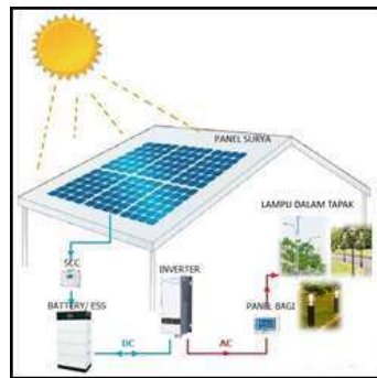
Gambar 4. 51 Alternatif 2 Distribusi Listrik Tapak.
