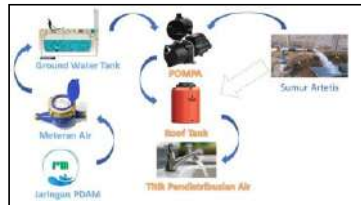
Gambar 5. 13 Jaringan Air Bersi Dengan PDAM
