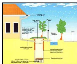
Gambar 5. 15 sistem drainase tapak
