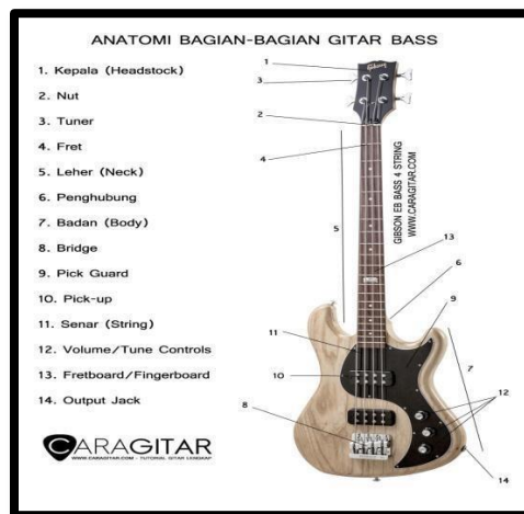
Gambar 1.1 anatomi bagian bagian gitar bass (dokumentasi, https://id.wikipedia.org/wiki/Gitar_bas )
