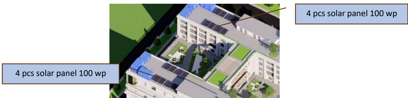
Gambar 72 Penempatan solar panel di roof top
