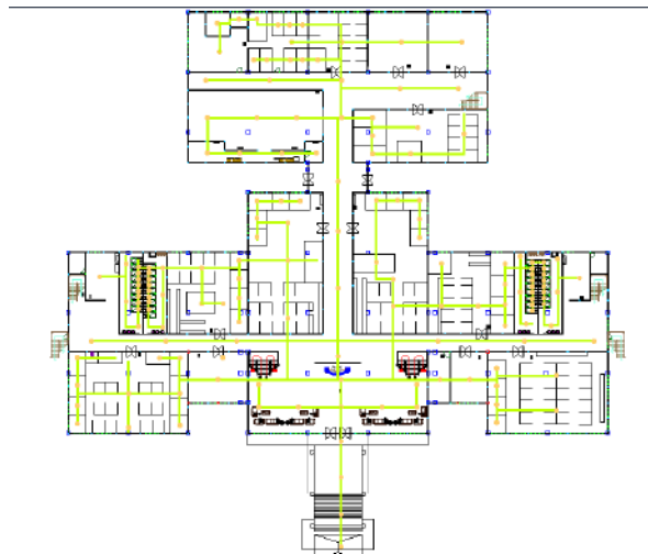
Gambar 5. 22 Sistem Jaringan Listrik
