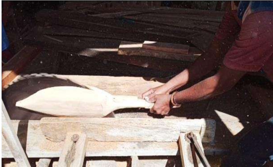
Gambar 4. 30 Proses Pembelahan Bagian Badan Ketadu Mara (Dok. Asra 2024)
