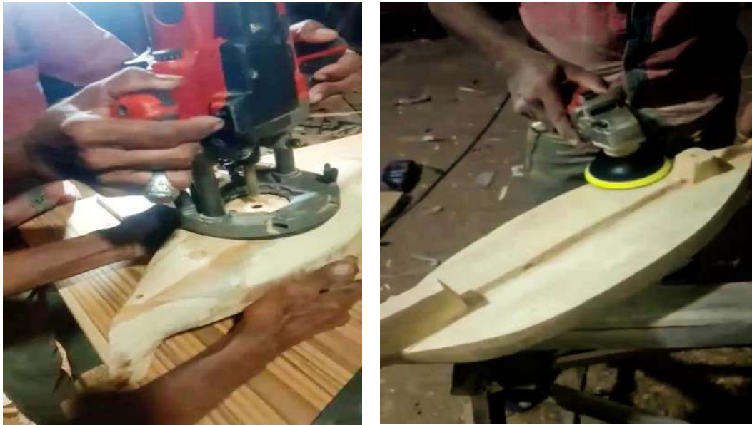
Gambar 4. 33 Proses Pembuatan Lubang Suara dan Proses Perataan Kayu (Dok. Asra 2024)
