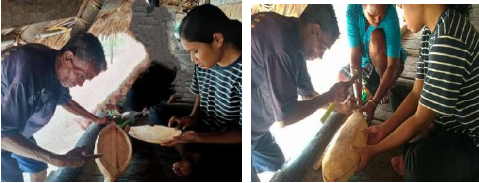
Gambar 4. 32 Proses Pengeleman dan Pemasangan Paku (Dok. Asra 2024)
