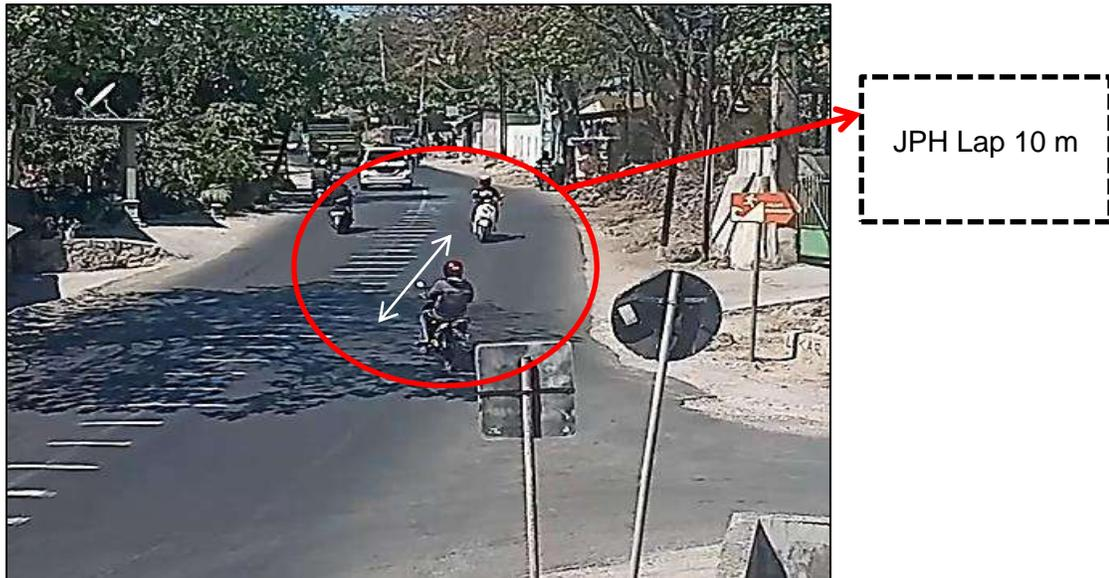
**Gambar 4.3 Pengukuran JPH Lapangan Berdasarkan Hasil Survei Secara Visual**
