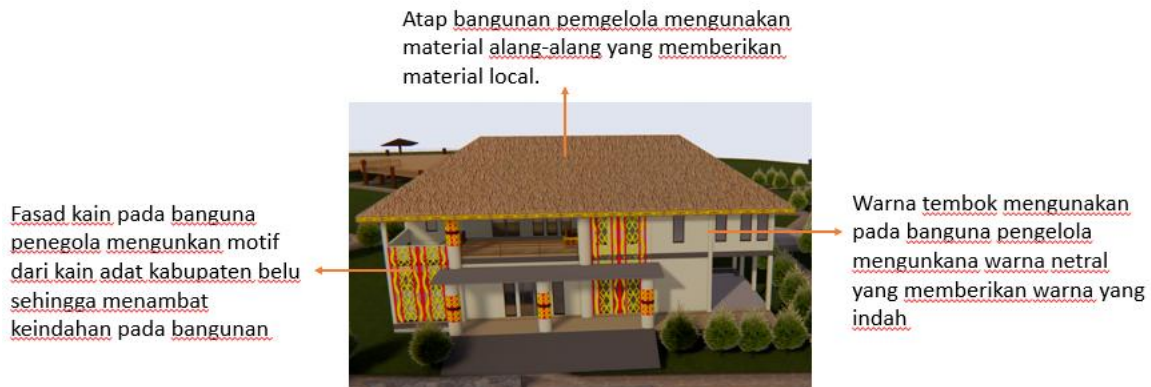
Gambar 5.12 Konsep Material Bnagunan Sumber : Olahan Pribadi,2025
