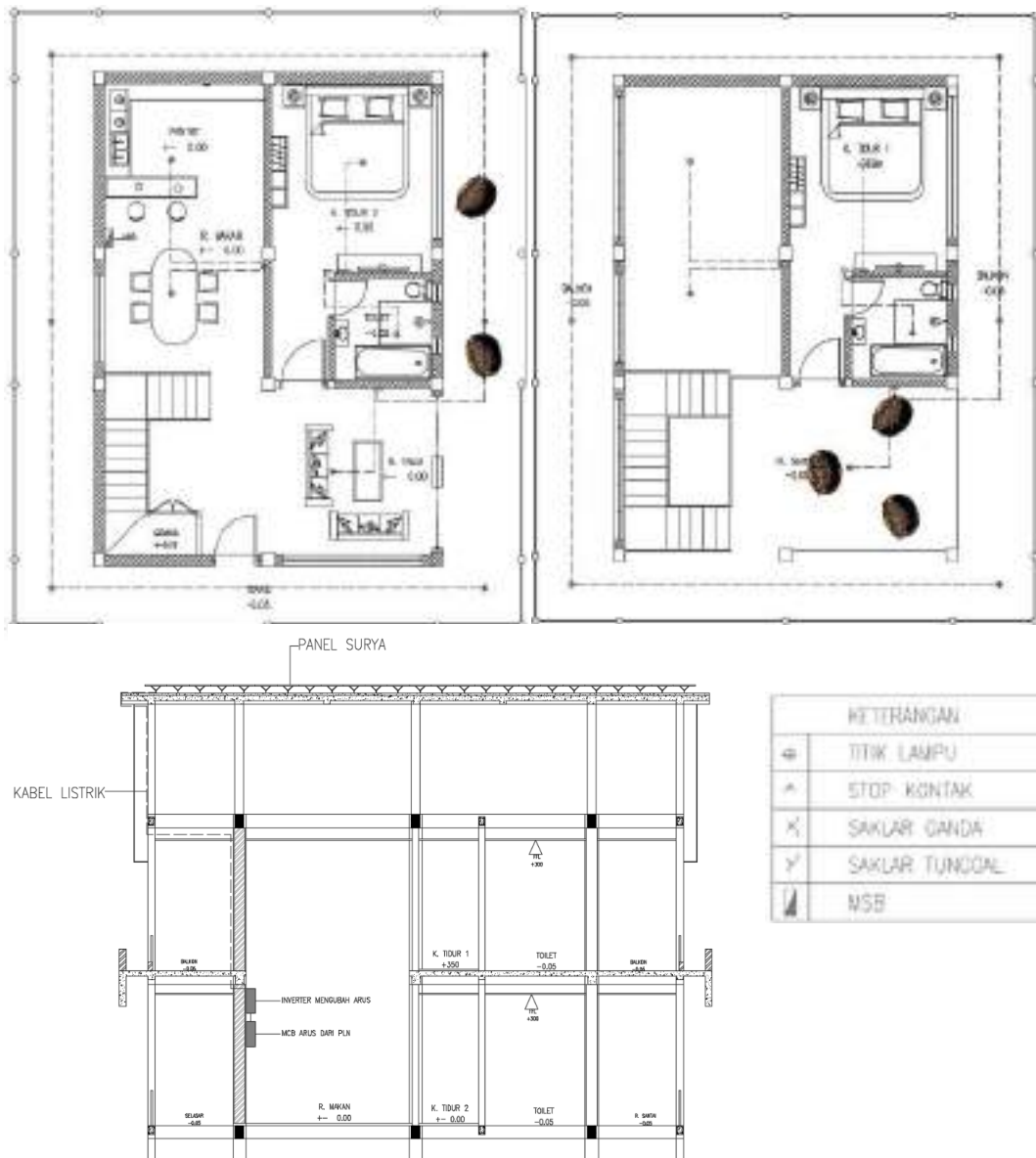
Gambar 5. 23 Sistem Jaringan Listrik Pada Bangunan
