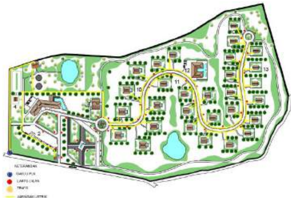
Gambar 5. 11 Jaringan Listrik Pada Tapak
