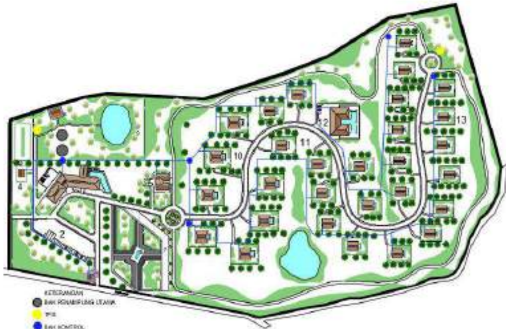
Gambar 5. 12 Jaringan Air Pada Tapak
