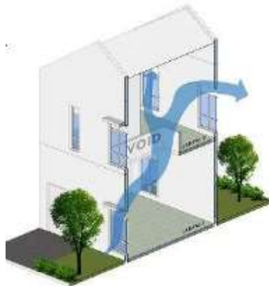
Gambar 4. 33 Alternatif 1 Penghawaan bangunan
