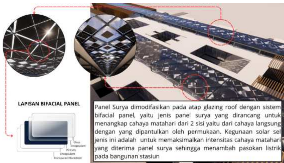
Gambar 5. 18 Solar Sel Pada Glazing Roof
