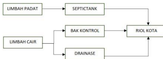
Gambar 5. 18 Konsep Utilitas Air Kotor
