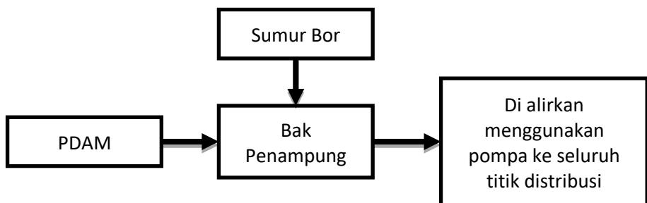
Dalam System ini pipa distribusi langsung dari tangki bawah (ground Tank) dengan pompa langsung di sambungkan dengan pipa utama penyediaan air bersih pada bangunan. Dalam hal ini menggunakan kemampuan pompa sepenuhnya
