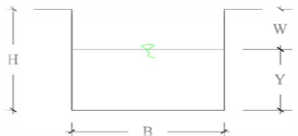
Gambar 2.8 Saluran Bentuk Persegi (SNI 03-3424-1990)
