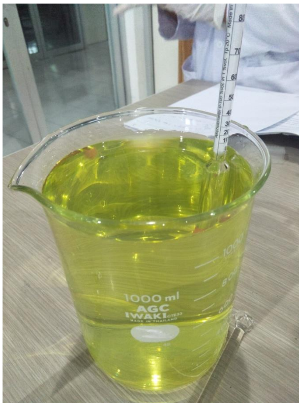
Uji Bebas Metanol Dengan Alkohol Meter
