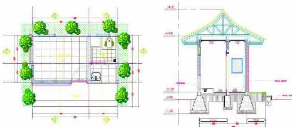
Gambar 82. Denah dan Potongan Pos Jaga dan Pos Polisi
