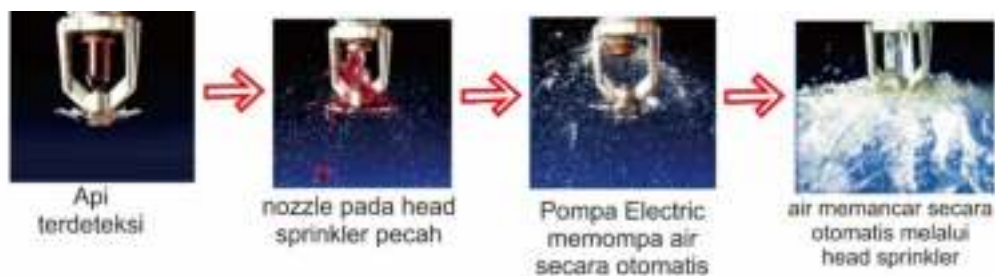
Gambar 5.16 Sistem Kerja Sprinkler
