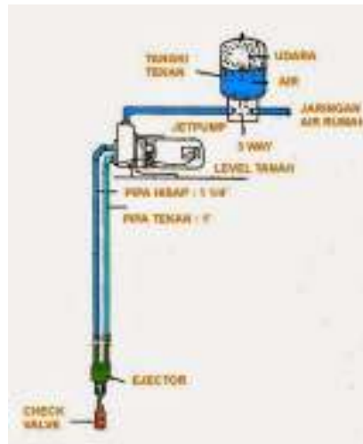
Gambar 74. Sistem Jaringan Sumur Bor
