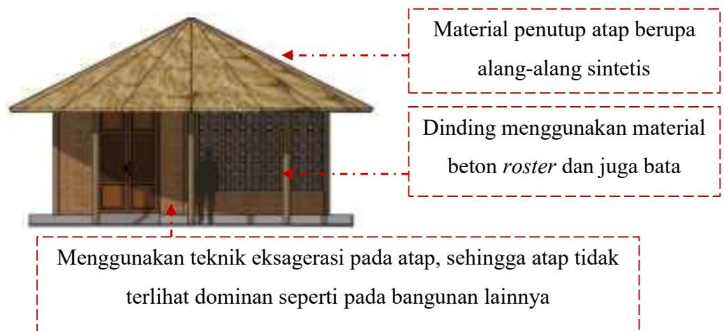
Gambar 5.23 Tampak depan Rumah pompa (Sumber : sketsa penulis)
