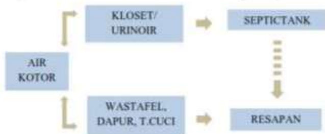
Bagan 5. 3 Skema distribusi air kotor dan air bekas pada bangunan (Sumber: Hasil analisa penulis, 2022)
