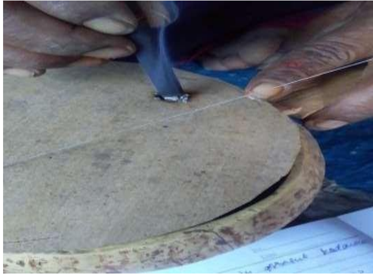
Gambar 40. Pembuatan Lubang Resonansi Dok.Peneliti : 2022
