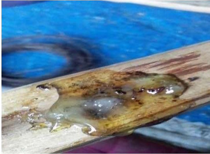
Gambar 37. Proses Merekatkan Getah Kenari dan Membakar Dok.peneliti : 2022
