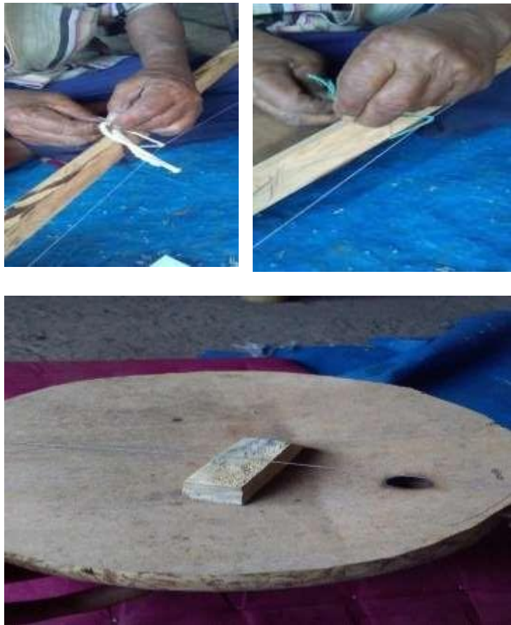
Gambar 41. Pemasangan Tali Pengencang,Tali Penyetem, dan Bridge Dok.Peneliti : 2022
