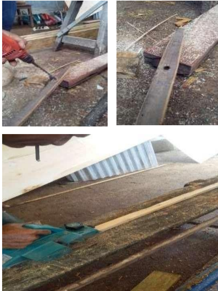
Gambar 28. Kayu Dibuat Lubang Lalu Dirapihkan Dok.Peneliti : 2022
