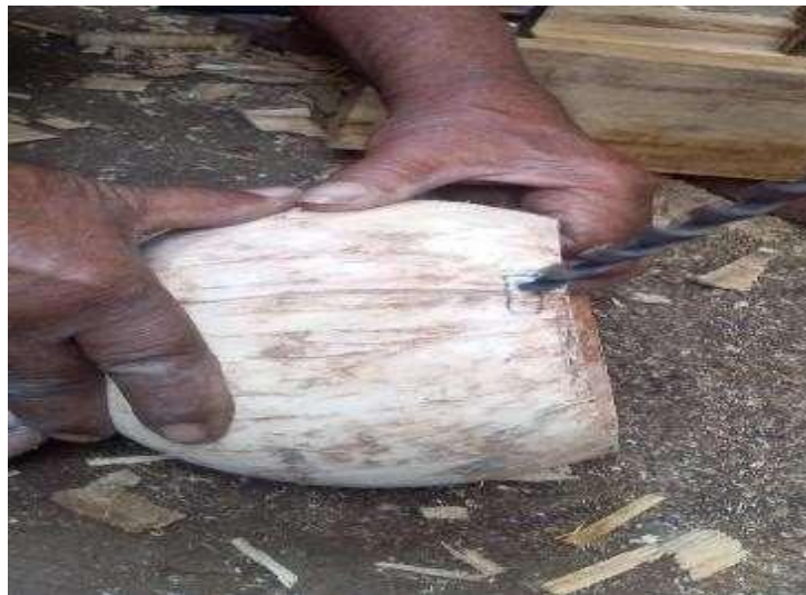
Gambar 25. Pembuatan Lubang Pada Tempurung Dok.Peneliti :2022
