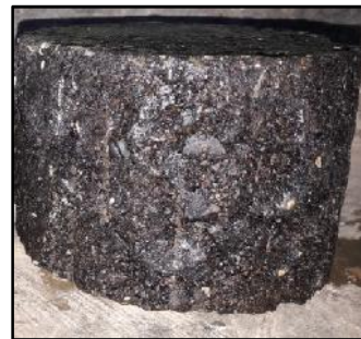
Gambar 1.b Dominan Agregat Kasar
