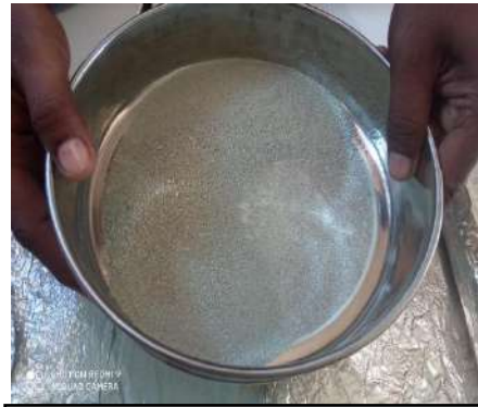
Pengayakan Zeolit dengan ayakan 100 mesh
