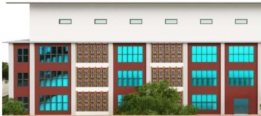
Gambar 5.12 Sunshading sebagai filter cahaya matahari
